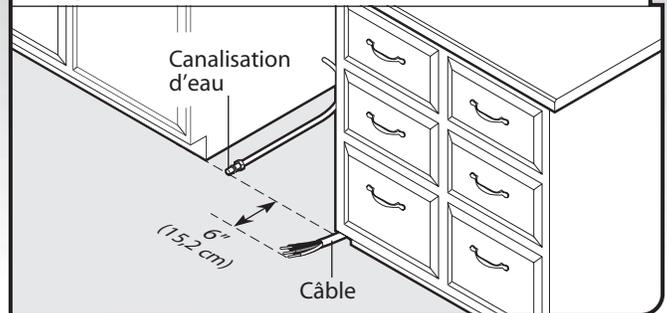
Si la canalisation d'eau et le câble disponibles satisfont les critères indiqués sur l'illustration (longueur et position), passer à la section "Installation du tuyau d'évacuation"; si ces éléments ne sont pas assez longs, voir les instructions à la section "Préparation de la cavité d'encastrement - Nouveaux moyens de raccordement".
